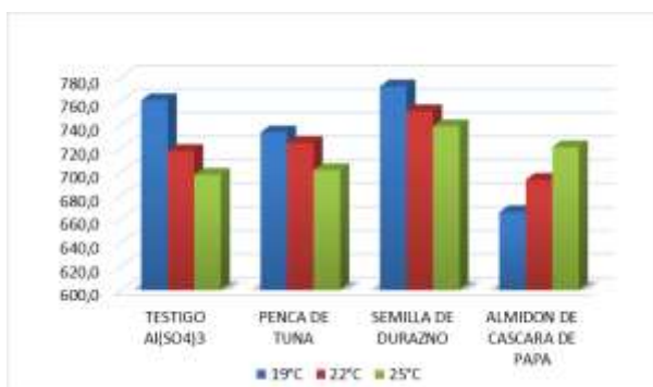
Figura 3. Conductividad eléctrica después de tratamientos con diferentes coagulantes a diferentes temperaturas.
