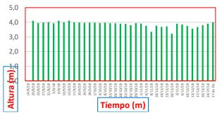
Figura 12. Altura de recarga del pozo superficial dos (m) en E.E. Patacamaya.
