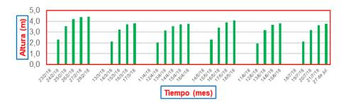
Figura 6. Recarga de agua del pozo superficial dos (m)
