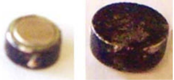
Pila de litio extraída, se observa el deterioro en una de sus caras
