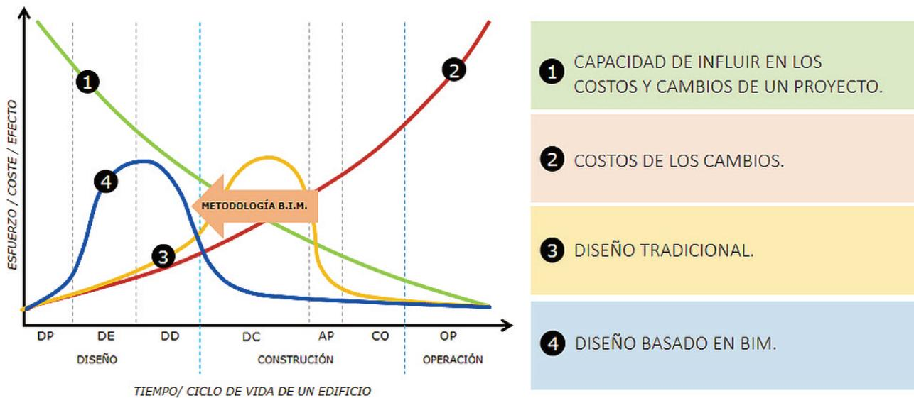
DP: DISEÑO PREVIO / DE: DISEÑO ESQUEMÁTICO / DD: DESARROLLO DE DISEÑO/ DC: DOCUMENTACIÓN / AP: APROVISIONAMIENTO / CO: CONTROL DE OBRA / OP: OPERACIÓN.
