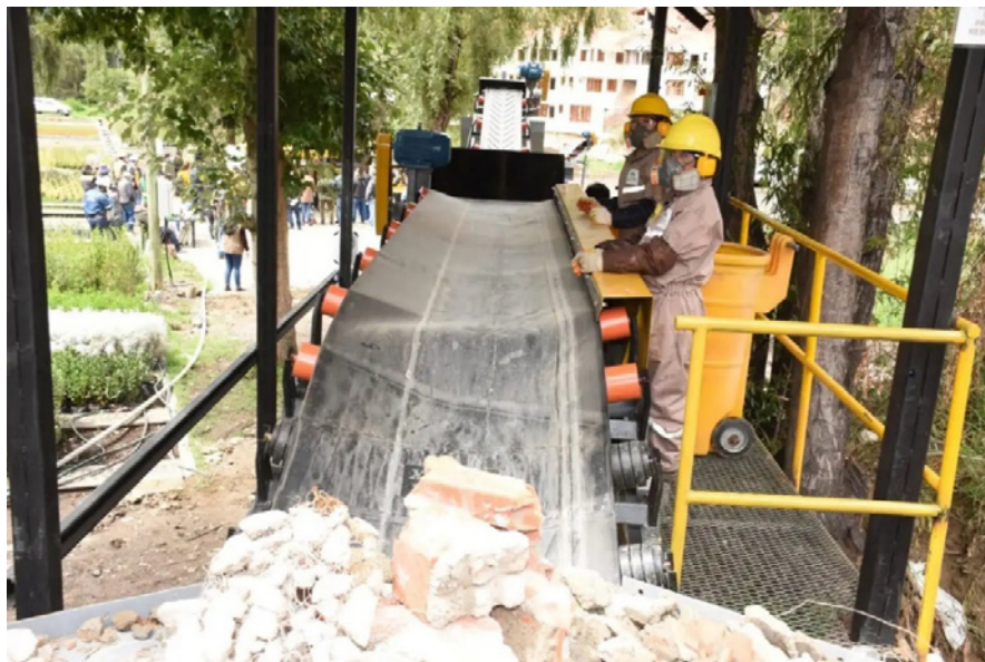
Figura 1. Planta piloto de transformación de residuos RCD,
