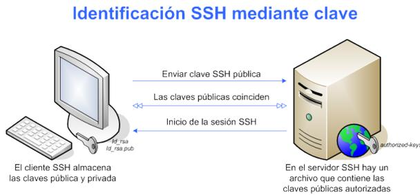
Figura 9: Identificación mediante llaves SSH
