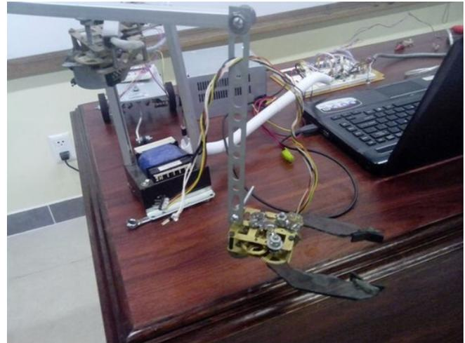
Figura 7. Mecanismo para brazo mecánico más garra de sujeción
