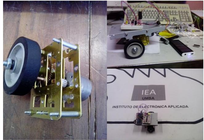
Figura 6. Mecanismo para un seguidor de línea
