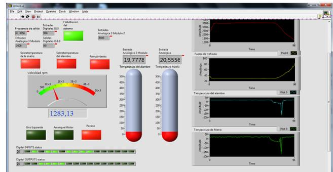
Figura 18: Flujo de datos en el sistema SCADA para el control de velocidades de la trefiladora seca
