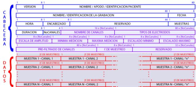
Figura 2: Estructura del encabezado y datos del formato EDF
