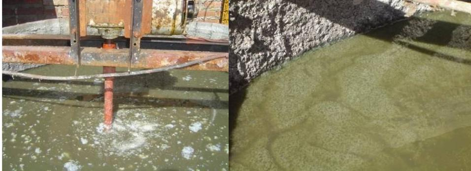
**Figura 10:** Coagulación de proteínas por adición de floculante y coagulante (izquierda) y lodos en el fondo del decantador (derecha).
