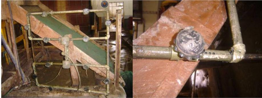
**Figura 3:** Sistema de aireación para aguas de pelambre, a la derecha se ve el detalle de las clapetas construidas en la empresa
