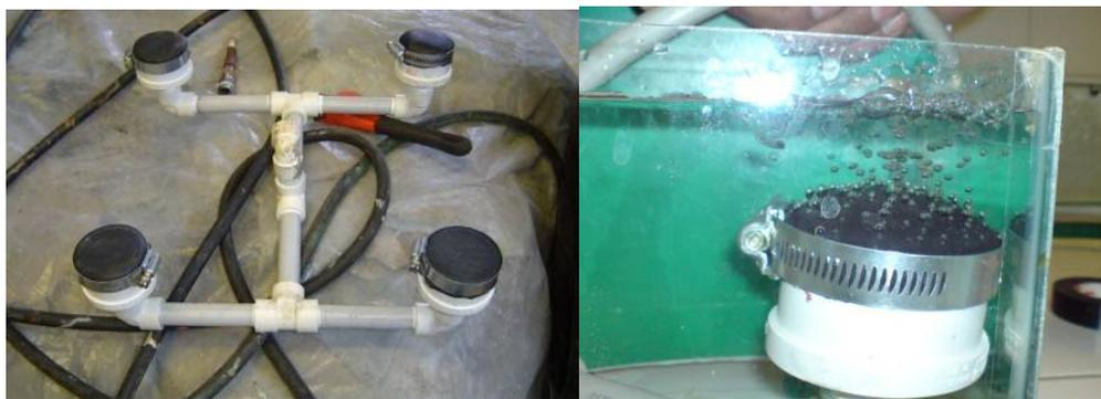
**Figura 12:** Sistema de aireación piloto (izquierda) y generación de burbujas mediante las clavetas.
