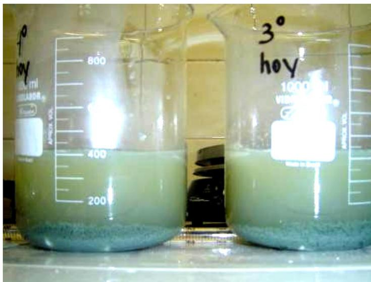
**Figura 8:** Precipitación materia orgánica en el licor de pelambre con  $\text{Al}_2(\text{SO}_4)_3$  como coagulante y Ciflox OFX como floculante.
