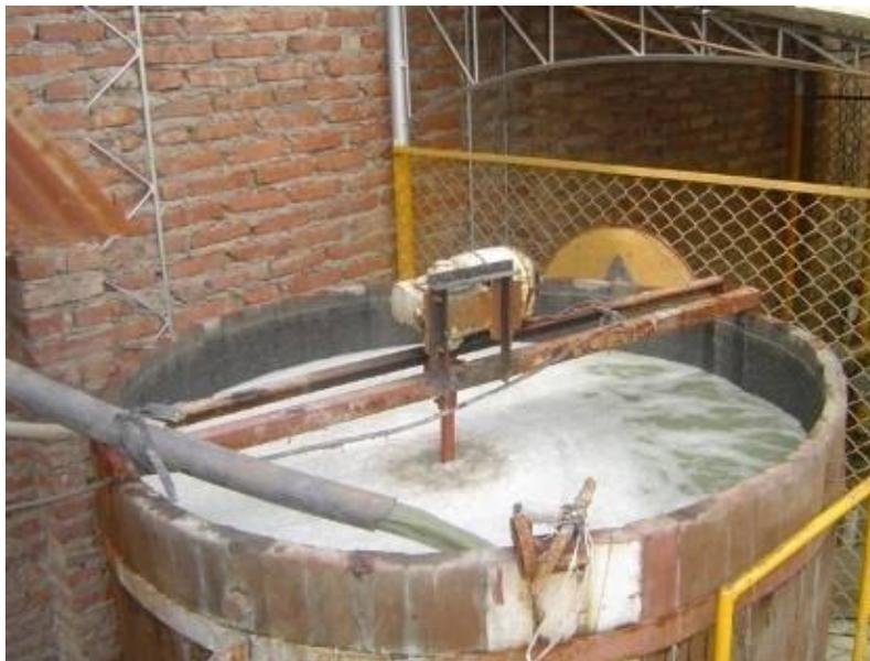
**Figura 9:** Detalle del tanque de decantación y sistema de agitación para las pruebas piloto.
