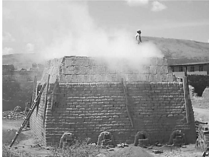
**Figura 1:** Horno tipo volcán utilizado por los ladrilleros artesanales en la zona de Champa Rancho en la ciudad de Cochabamba.
