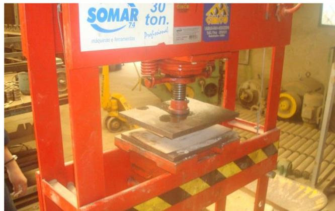
**Figura 20.** Prensa mecánica utilizada en el ensayo de resistencia a la compresión.
