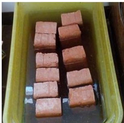
**Figura 22.** Ensayo de absorción de agua.
