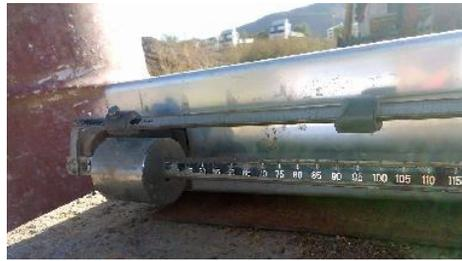
**Figura 6.** Balanza para el ensayo de acuerdo a la NB 743.
