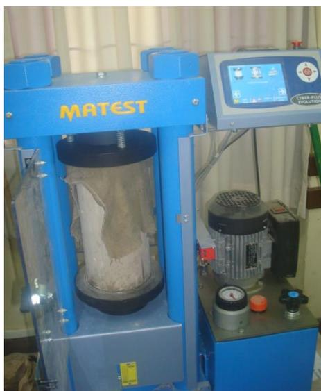
**Figura 19.** Prensa utilizada en el ensayo de resistencia a la compresión.
