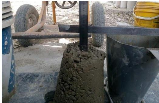
**Figura 18.** Ensayo de “Cono de Abrams”
