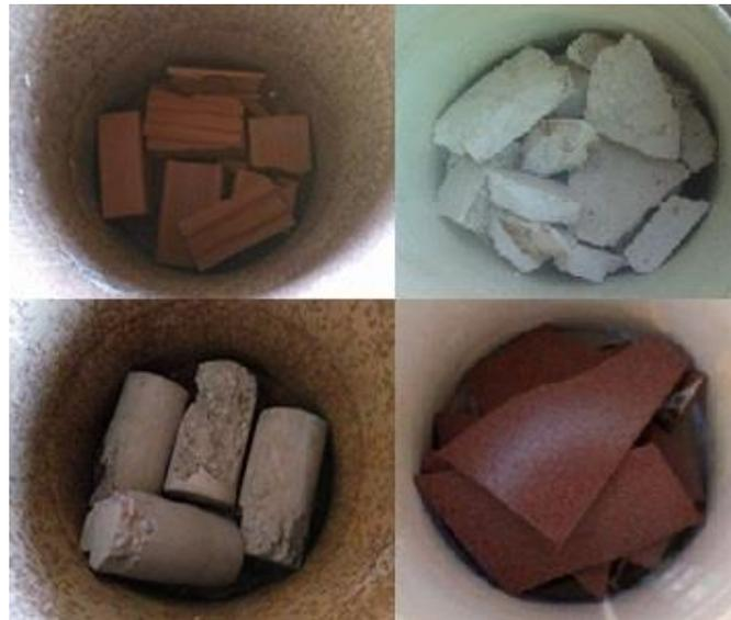
**Figura 7.** Materiales utilizados en el ensayo de acuerdo a la NB 743.
