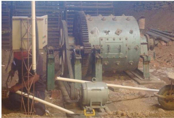
**Figura 17.** Molino de bolas necesario para la propuesta de revalorización de los residuos de construcción y demolición en la ciudad de Cochabamba.
