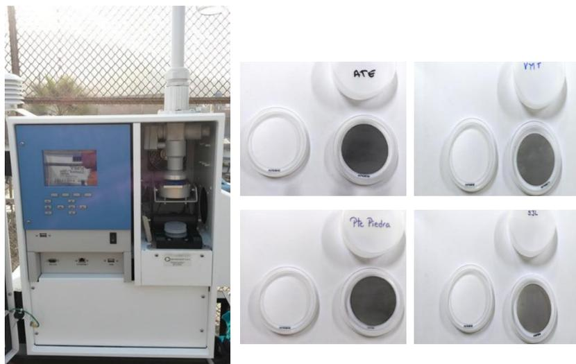
Figura 2: Muestreador de bajo volumen (izquierda). Muestras de filtros que indican el color inicial antes y después del periodo de muestreo en Ate (superior izquierda), Villa María del Triunfo (superior derecha), Puente Piedra (inferior izquierda) y San Juan de Lurigancho (inferior derecha) Análisis por microscopía electrónica de barrido (MEB)
