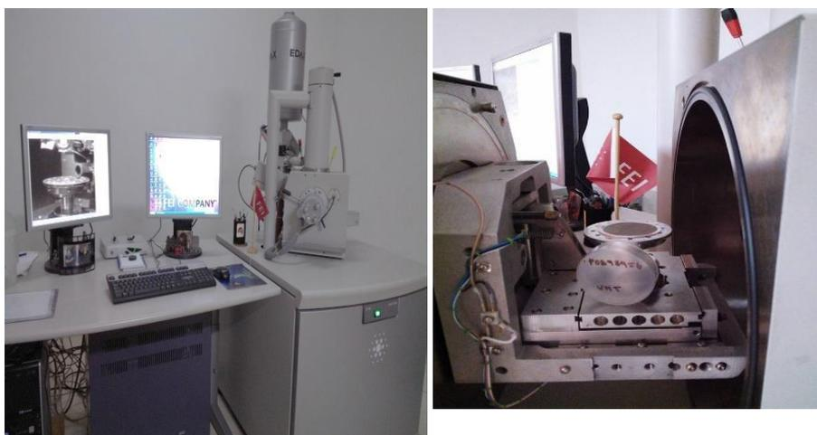
Figura 4: Microscopio electrónico de barrido Semfe Quanta 200 con un espectrofotómetro EDS acoplado
