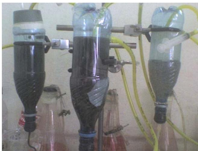
**Figura 1. Biorreactores. Papel como soporte y fuente de carbono (izquierda), cerámica como soporte + AGV como fuente de carbono (centro) y agar-agar como soporte + AGV como fuente de carbono (derecha).**
