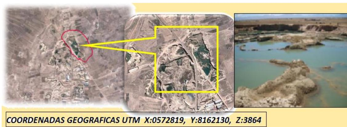
Figura N° 2. Uno de los frentes de explotación de material arcilloso en la zona de Viacha que ha creado una "fosa de por lo menos 9 Km<sup>2</sup> por 2 a 10 metros de altura.
