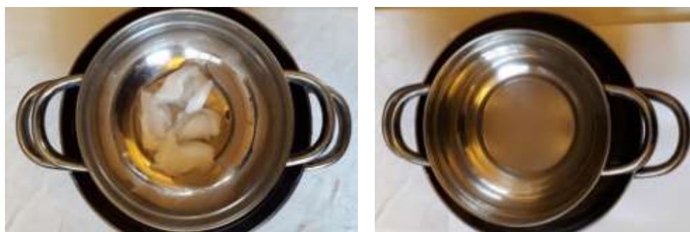
Figura 3. Adición de jalea de vaselina (Izquierda) y jalea de vaselina completamente derretida (Derecha).
