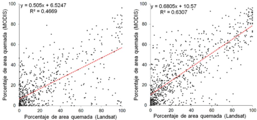
**Figura 6.** Diagrama de dispersión de cartografía de aéreas quemadas de 500 m de MODIS, versus cicatrices de referencia a partir de imágenes Landsat de 30 m. Se calcula el coeficiente cuadrado de correlación lineal,  $R^2$ , para la Amazonía con un nivel de exactitud de 47% y 63% para la Chiquitanía.
