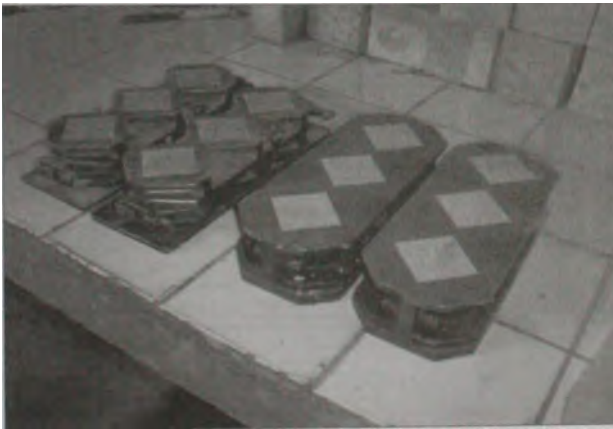
Foto 5. Probetas de 50.8 mm de lado, antes del desmoldado. A la edad de 28 días se hace el ensayo a compresión.
