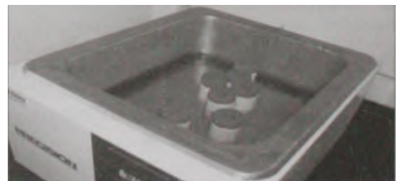
Foto 3. Recipientes que contienen las muestras de arena y solución de NaOH 1N, contenidas en baño maría.
