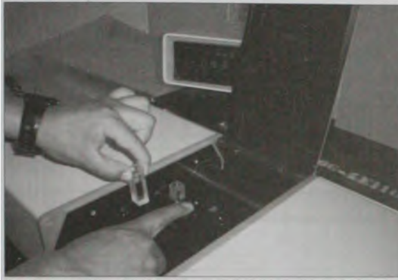
Foto 4. Colocación de las muestras de ensayo en el fotómetro a 410 nm, para realizar las lecturas de absorbancia.
