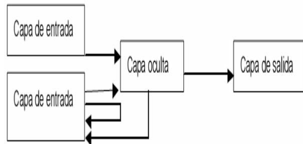
**Arquitectura de Propagación hacia Atrás, Conexión Recurrente**
