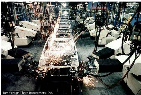
Los robots sueldan piezas de un automóvil en la línea de producción automatizada de una fábrica. A medida que han ido avanzando la tecnología informática y la robótica, los robots han sido capaces de efectuar tareas cada vez más complicadas.
