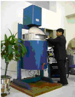
Mezclador multiuso con dispositivo de control automático
