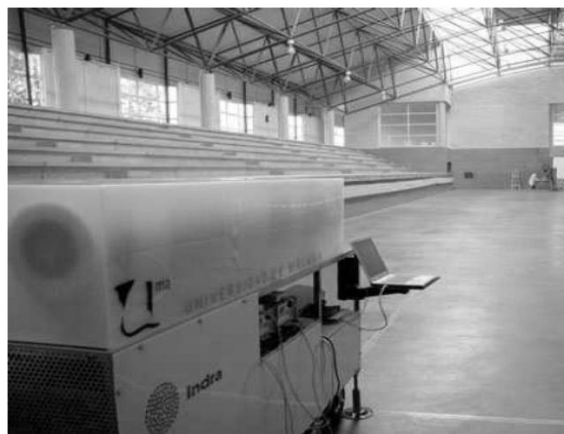
Figura 4: prototipo LIBS de doble pulso, al fondo de la imagen se ve el blanco donde se depositaron los materiales a analizar
