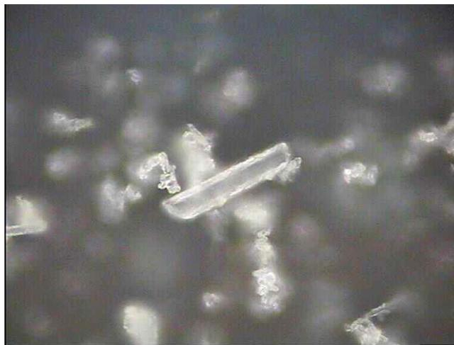
Figura 4. Microfotografía de los cristales de fluotantalato de potasio.
