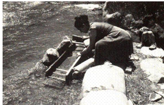
Figura 2. Beneficio de minerales en una canaleta móvil
