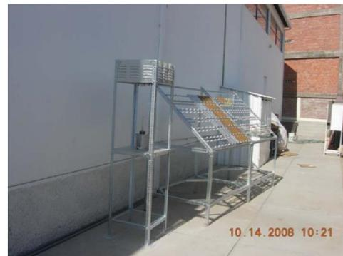
Fotografía 1. Vista general de la Estación Cochabamba, con el panel de exposición y la caseta para instalación de dispositivos para determinación de contaminantes.
