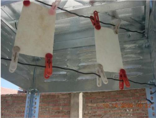
Fotografía 2. Placas alcalinas instaladas en la caseta para la determinación de deposición de SO<sub>2</sub>.
