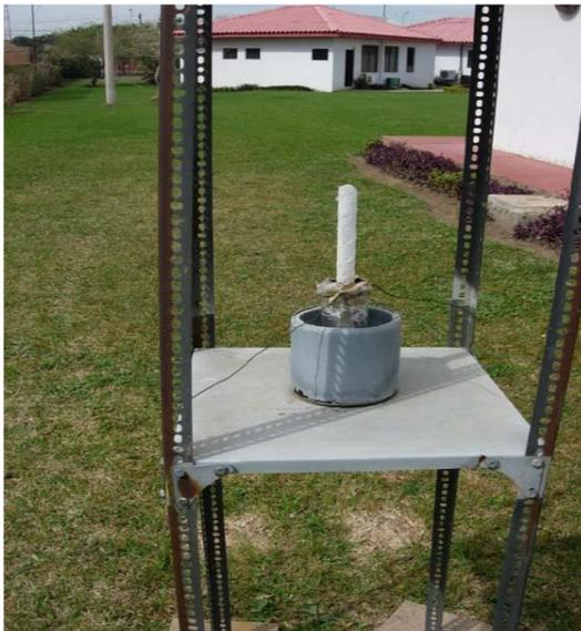
Fotografía 3. Colector de cloruros, método de la Vela Húmeda.
