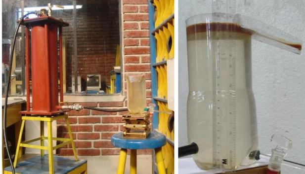
Fotografía 2. Equipo de laboratorio: Saturador -Celda de flotación
