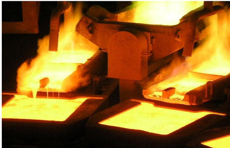
Figura 4. Moldeo de ánodos de cobre. Mexicana de Cobre, Grupo México, planta Sonora.
