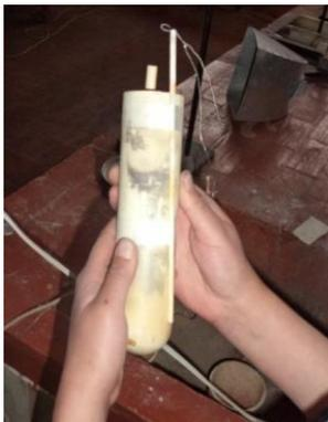
Figura 4. Detalle del crisol utilizado en la experimentación.
