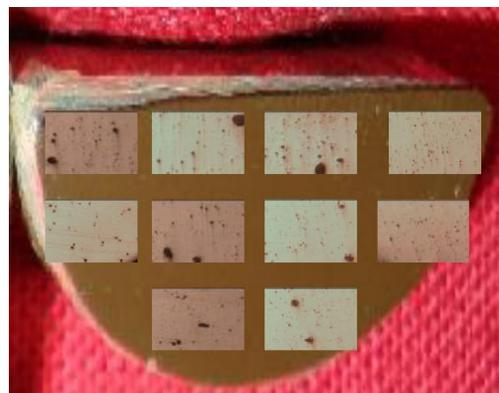
Probeta de 1" colada en matriz metálica.
