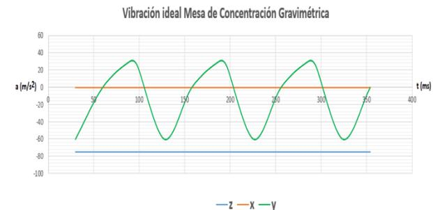
**Figura 8.** Diagrama de vibración ideal de una mesa de concentración gravimétrica vibrante.
