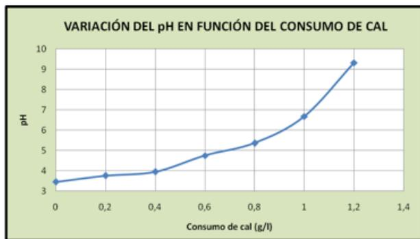
**Figura 1.** Curva de neutralización-precipitación (variación del pH en función al consumo de cal) de las aguas ácidas de mina.
