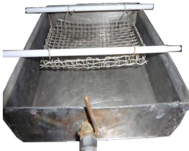
Figura 2. Celda Balbach-Thum habilitada para pruebas en laboratorio.
