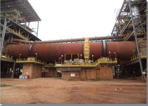
Figura 7. Secador rotatorio de la fundición de Onça-Puma.
