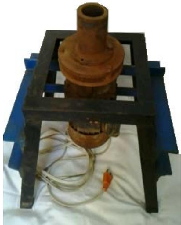
**Figura 1.** Equipo de colada centrífuga tipo vertical.
