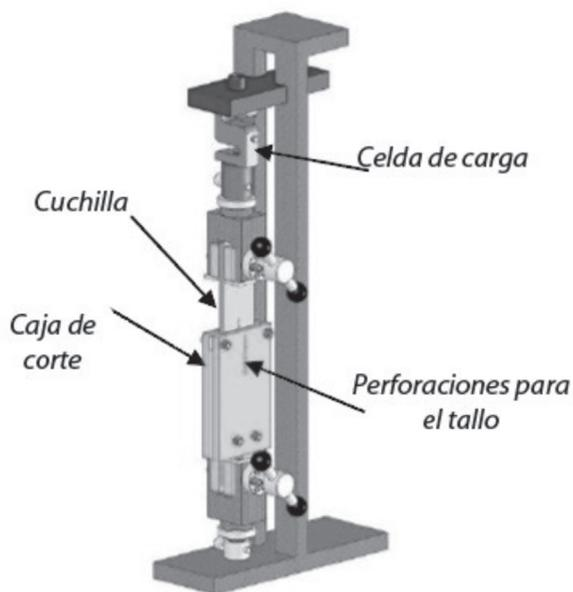
Figura 3. Prueba cortante por “Caja de Corte”.
