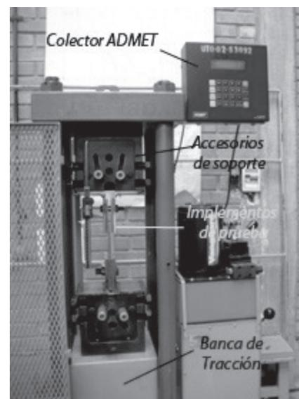
**Figura 11. Banca de tracción con colector ADMET.**
