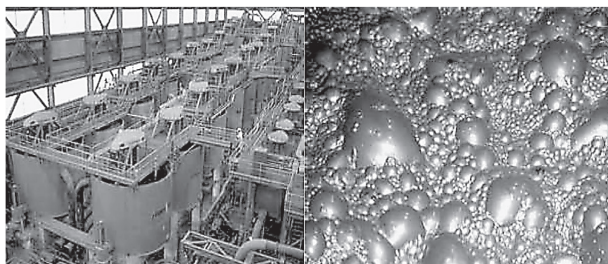
Fotografía 8 y 9. Celdas de flotación. Concentrado mineral flotado. Crédito [5]
