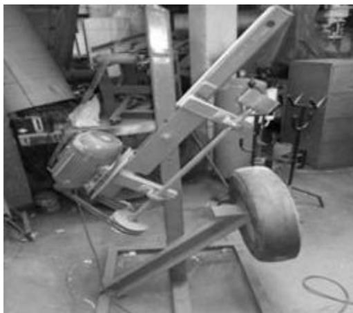
Fotografía 2: Máquina cortadora laterales y banda de rodadura. Crédito: Díaz, M., Castelú, P. 2016
