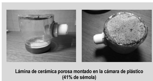
Lámina de cerámica porosa montado en la cámara de plástico (41% de sémola)
