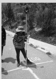
Levantamiento de puntos de control terrestre PCT
