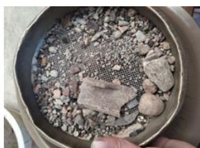
**Fotografía 4:** Tamizado de muestra K1, presencia de cerámicas, ladrillos, material orgánico, entre otros. Crédito: W. Aliaga - S. Paco (2023).
