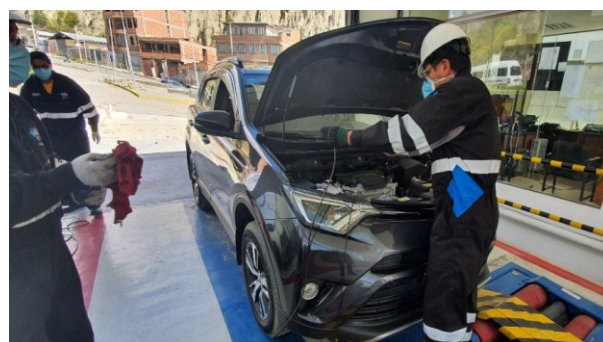
Fotografía 1: inspección CRTV, emisión de gases contaminantes vehículo de prueba. El procedimiento se inicia instalando los cables del sensor de temperatura en la vaina tubular del aceite y el sensor magnético de rpm en el motor. Analizador gases de escape MAHA 6.2.
