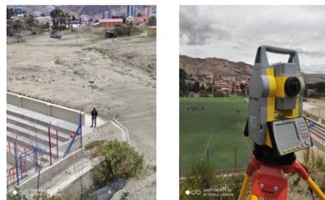
Levantamiento con Estación Total (ET).
