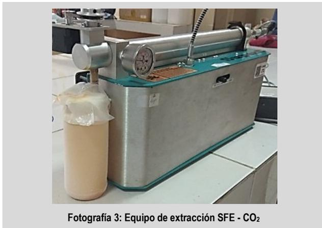
Fotografía 3: Equipo de extracción SFE - CO<sub>2</sub>
