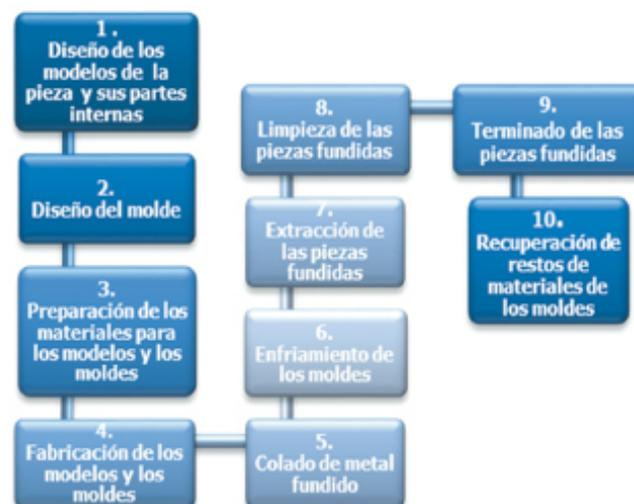
Figura 6. Proceso productivo carpintería metálica
