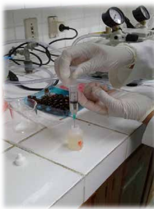
Figura 3. Preparación del extracto de cebolla para luego inyectarla en el Equipo HPLC y cuantificar el contenido de quercetina
