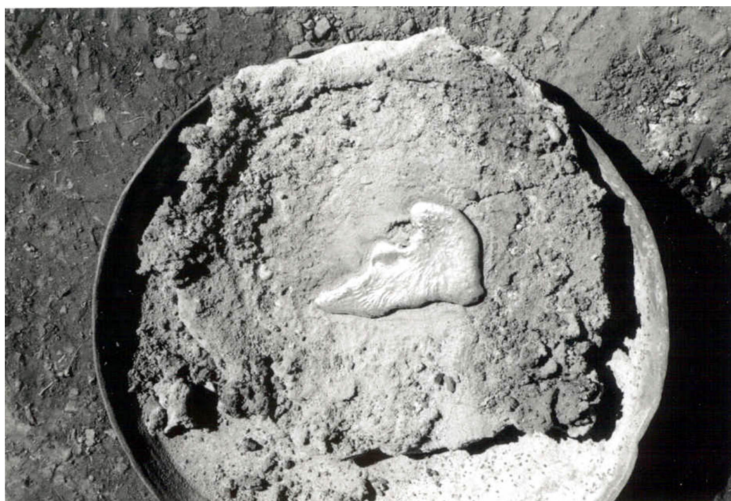
Figura 3. Plata terminada sobre una torta de asendrada que ha sido retirada del piso del horno.
