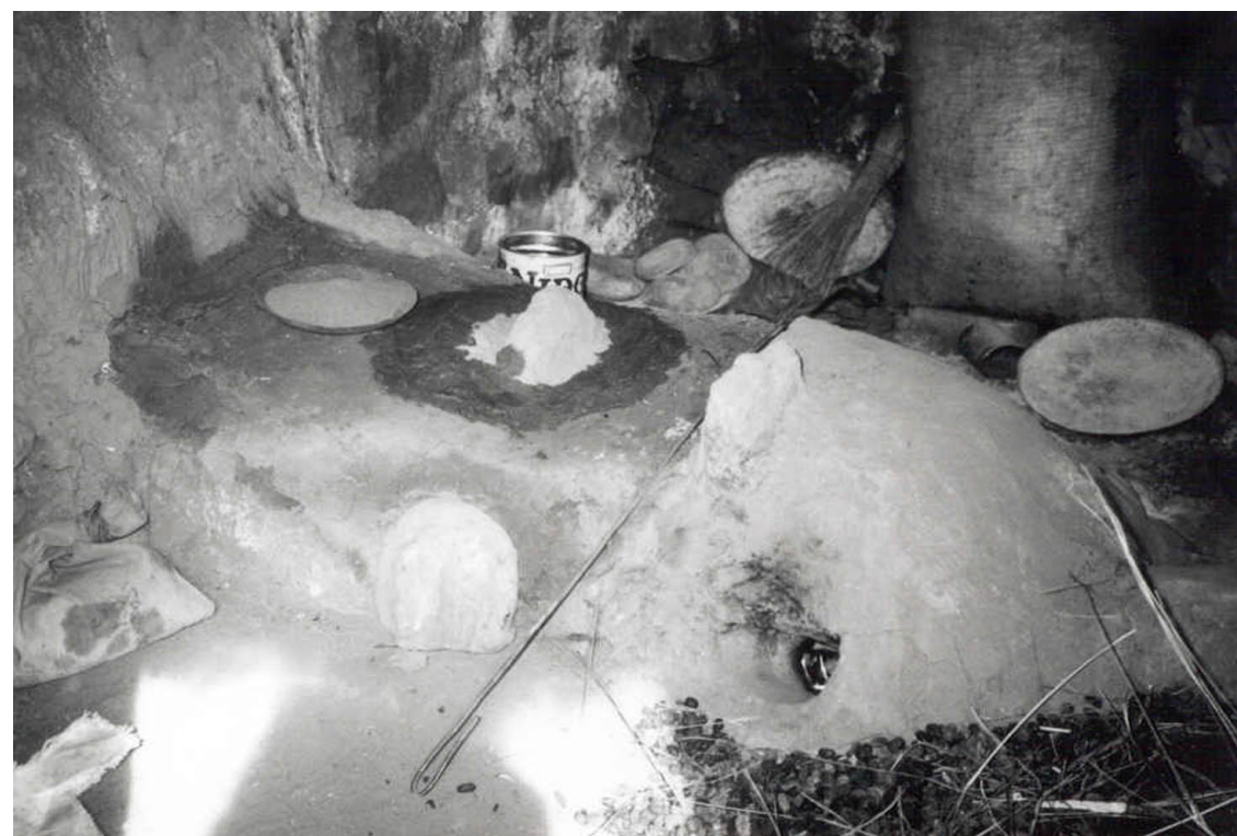
Figura 2. Horno de reverbero utilizado por Don Carlos Cuiza para producir plata.
