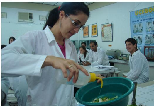
Las muestras fueron lavadas con agua destilada para extraer la tierra presente en las mismas, en un vaso de precipitación de 500 ml. La solución de agua con tierra es vertida posteriormente a 6 tubos de ensayo cónicos para centrifugar por aproximadamente 10 minutos.
